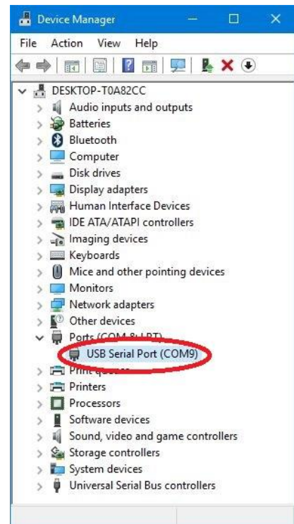
Εικόνα 4.7 Παράθυρο διαχείρισης συσκευών με κυκλωμένη τη θύρα που χρησιμοποιεί η πλακέτα ελέγχου.
